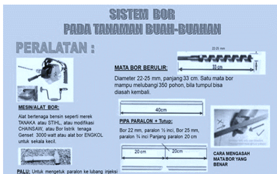
Gambar 1. Sistem BOR Pada Tanaman Buah-buahan
